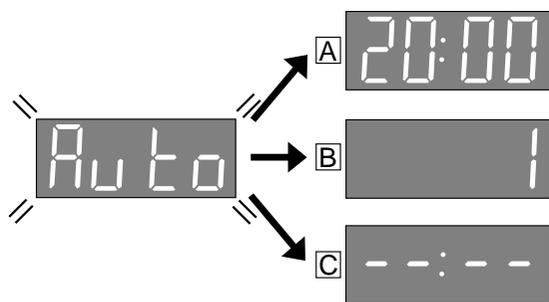
• Si le réglage automatique des canaux et le réglage automatique de l'horloge ont tous les deux été effectués avec succès, l'heure actuelle correcte sera affichée.
