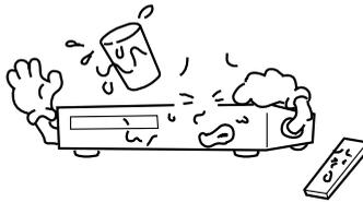
Ne pas poser d'objets susceptibles de se renverser sur le dessus du magnéscope ou de la télécommande
