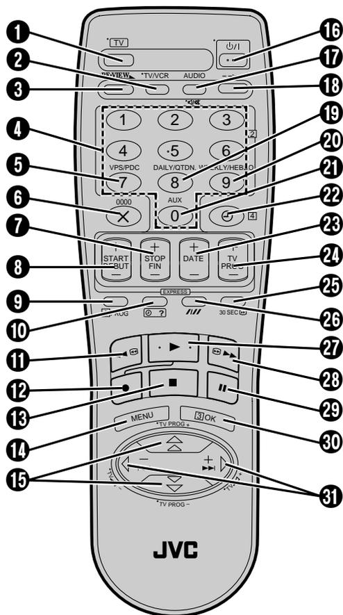
Les touches avec un petit point sur la gauche du nom peuvent également être utilisées pour commander un téléviseur JVC tout en maintenant pressée la touche TV. (☞ "Fonctionnement de téléviseurs JVC" à la page 53.)
